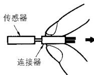
\* 3. EE-1006型是housing case，端子pin可个别对应，也有准备专用压着工具。
