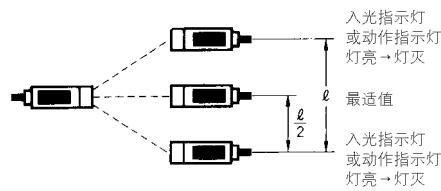
**光轴：**透镜中心和透镜焦点相连的轴，就称为光轴。（光的放射轴）
