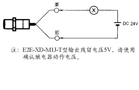
注：E2E-XD-M1J-T型输出残留电压5V，请使用确认继电器动作电压。
