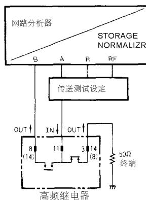
和测量无关的接点以50Ω结束。
