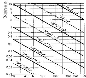
注: 低电压样式时, 因为和内部阻抗的关系, 有时无法对SSR施加十足的电压。请确认SSR的输入阻抗后, 选择R的值。
