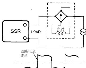
因此，交流用SSR在输出素子上使用TRIAC (回路电流未变成0时，素子不会OFF)，负荷电流波形为矩形波时，会导致SSR的复位不良。开关经全波整流的负荷时，请选择-V型或POWER MOS FET继电器。(-V型SSR) G3F-203SL-V型、G3J-203SL-V型(Power MOS FET继电器)
