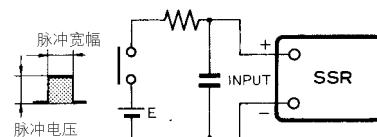
• 为了满足SSR的输入电压, 以和电源电压E的关系来决定R的上限。
