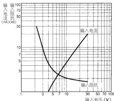
适用于无指示灯之光耦合方式机种的输入阴抗
